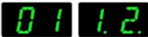
Если нужно отредактировать записанную сцену, в режиме программирования нажмите кнопку «INSERT», при этом номер сцены мигает с помощью кнопок "UP" и "DOWN" выберите, чтобы активировать сцену, которую хотите изменить. Затем нажмите кнопку «INSERT» еще раз, чтобы добавить новую сцену. Удалите старую выбранную, для этого нажмите кнопку «DELETE», выберите с помощью кнопок "UP" и "DOWN" ее номер, и нажмите еще «DELETE» раз. Нажмите кнопку «A» на 3 секунды, чтобы выйти из режима программирования.
