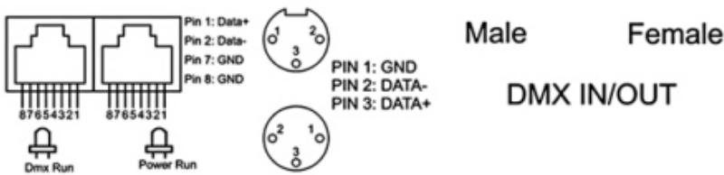
На конце кабеля максимально удаленного от передающего устройства устанавливается так называемый терминатор - нагрузочный резистор между двумя проводами с данными (штырьки 2 и 3 разъема XLR). Резистор-терминатор поглощает сигнал на дальнем конце кабеля и не позволяет ему отражаться. В качестве терминаатора обычно используется резистор номиналом 120 Ом мощностью 0,25 Вт. Терминатором также может служить 3-х штырьковая вилка
